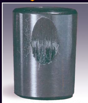
Extrem lagerskada vid 3,5, ton pr. m 2
